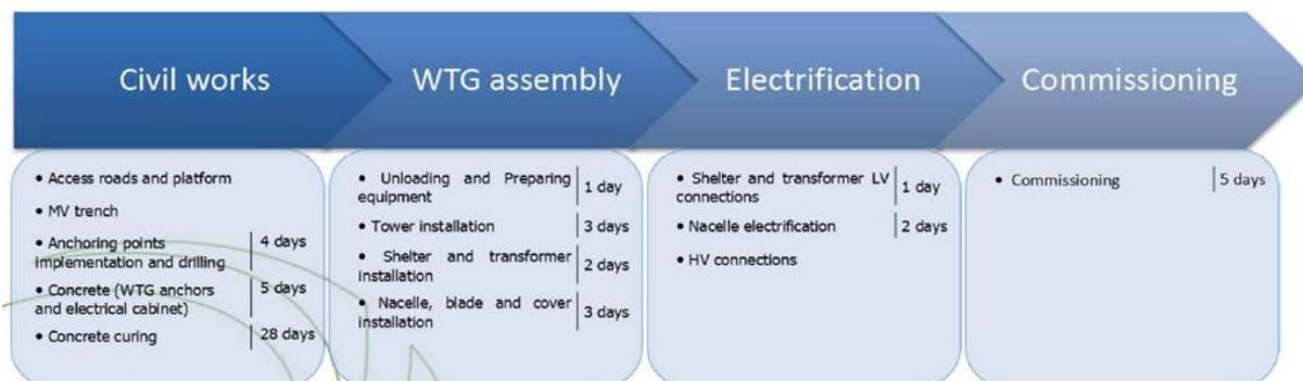
Figur 3-9. Normal arbeidsprosedyre ved installasjon av denne typen turbiner. Kilde: Vergnet.
