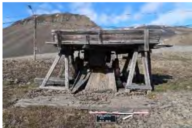
Figur 1 (øverst): Steinknuseren er plassert på to bjelker og bygget inn i en trekonstruksjon. Mot NNØ.
