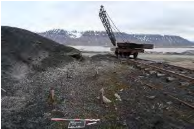
Figur 8: T.h. under kullhaugen sees trerampen som trolig er brukt til å skrape kull opp på transportbåndet. Mot SØ.
